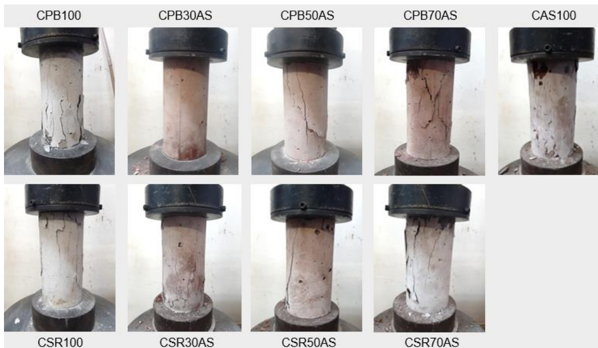
Figura 42 Tipos de ruptura do corpo de prova
