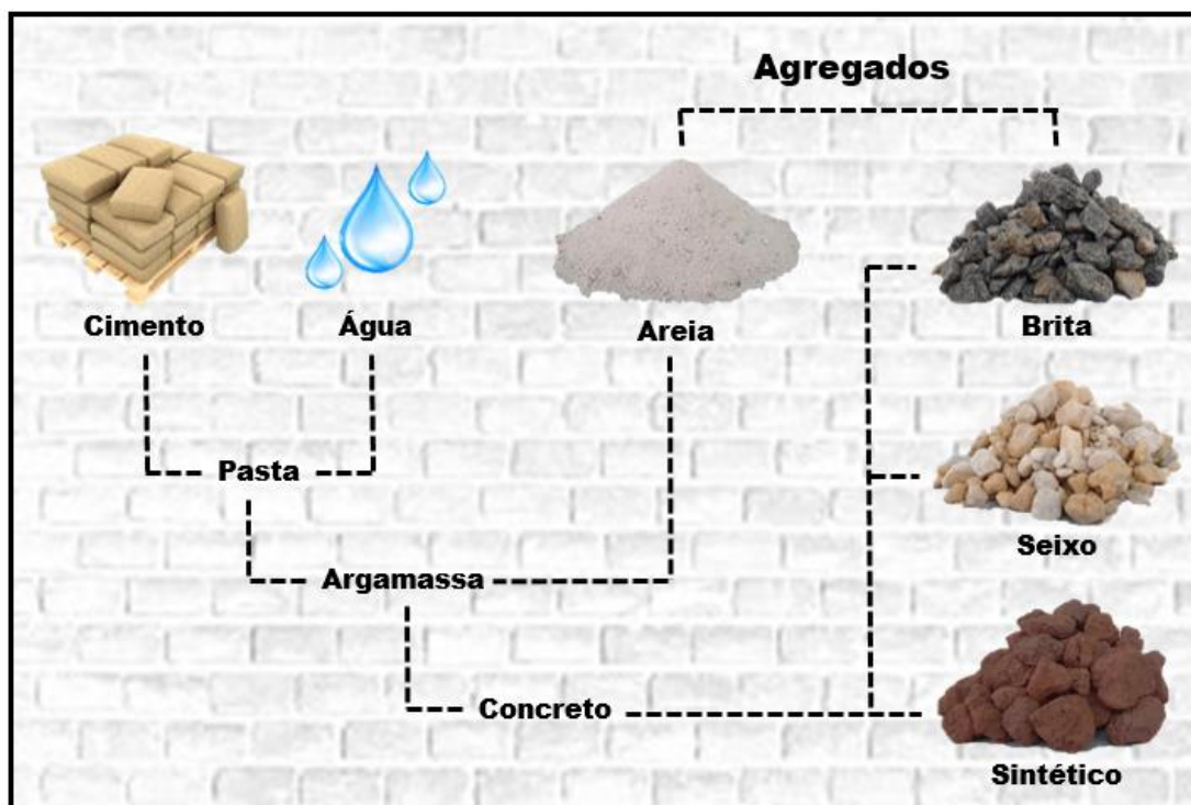
Figura 32 Fluxograma da execução do concreto
