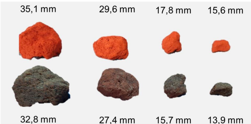
Figura 18 Agregados secos em estufa a 100°C e após a queima a 1000°C
