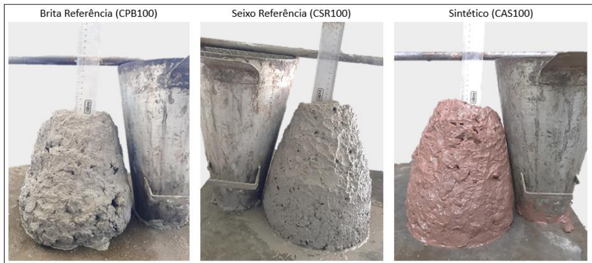
Figura 33 Abatimento de tronco de cone (Slump Test)
